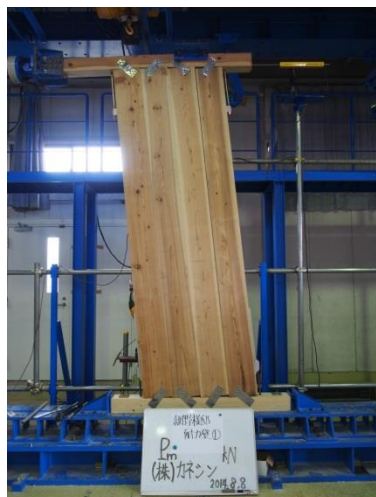
平角マッシュヴホルツによる耐震壁実験 (構造用ビスにより積層)
